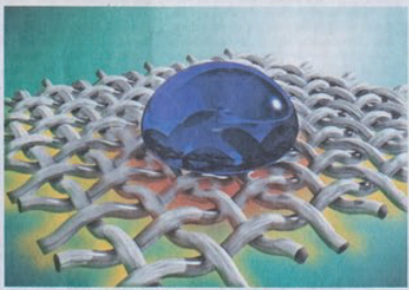
Textilgewebe mit Wassertröpfchen unter Mikroskop, nach dem Auftrag von Flüssigglas
